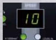
アングルヘッド(H211,H221,H231)をご使用時の実際の回転数は、表示回転数よりもギアを使用しているため、約5%下がった回転数となります。
