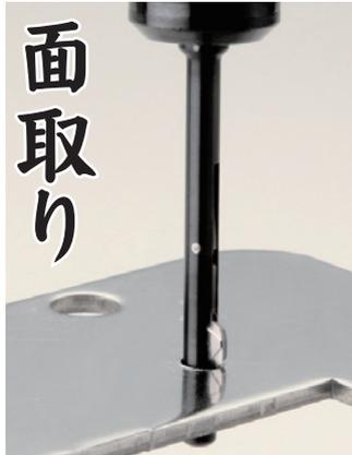
1Pack 1 Piece **ハイスブレードタイプ High Speed Steel Blades Type** Shank  $\phi 6.35$
