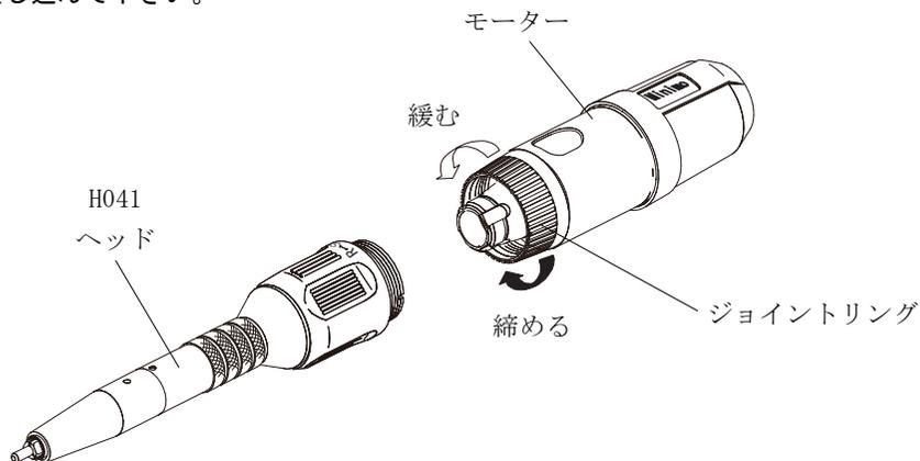
適合モーター： 全機種 ※KV11H, KV112Hを除く
