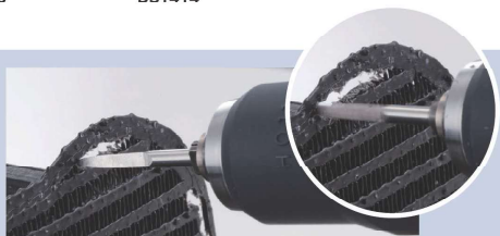
3Dプリンターサポート材 Support Material of 3D Printing 3D プリンターのサポート材除去中 Removing support material of 3D printing
